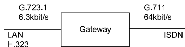
Abbildung 21 VoIP-Gateway/Gatekeeper mit H.323
